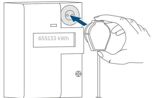
El imán integrado facilita la adherencia. En interfaces diseñadas de conformidad con la normativa, el cable se guía hacia abajo.
