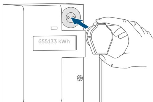
Il magnete integrato assicura l'adesione. Sulle interfacce realizzate in modo conforme alle norme il cavo corre verso il basso.
