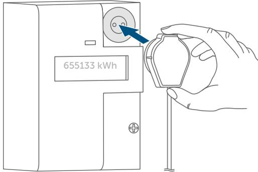
L'aimant intégré assure une bonne adhérence. Sur les interfaces réalisées conformément aux normes, le câble descend.
