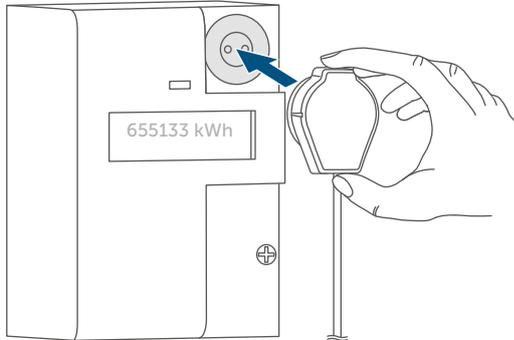
Der integrierte Magnet sorgt für die Haftung. Auf normkonform ausgeführten Schnittstellen läuft das Kabel nach unten.
