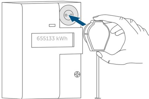
De geïntegreerde magneet zorgt voor de hechting. Bij interfaces die ontworpen zijn conform de normen, loopt de kabel naar beneden.
