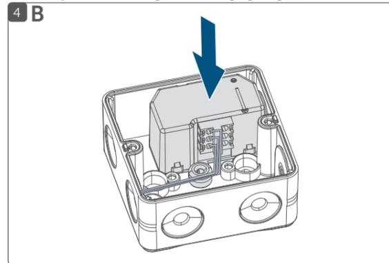
► Coloque el conmutador con el ojal de fijación (B) en la sujeción – aprítelo lo necesario.
