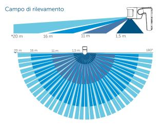
\*max. raggio d'azione fino a 20 m con un'altezza di montaggio di 2,5 m
